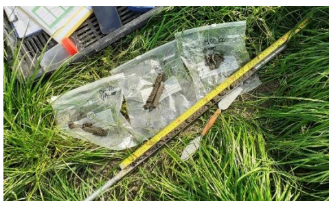
Figuur 4: Het uitsteken van de grondmonsters uit de guts, op de verschillende dieptes verzamelen van monsters.
