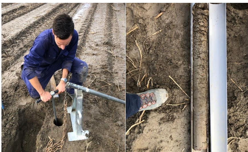
Figuur 29: Het nemen van de grond-kolommen met de grondkolomcilinderboor.
