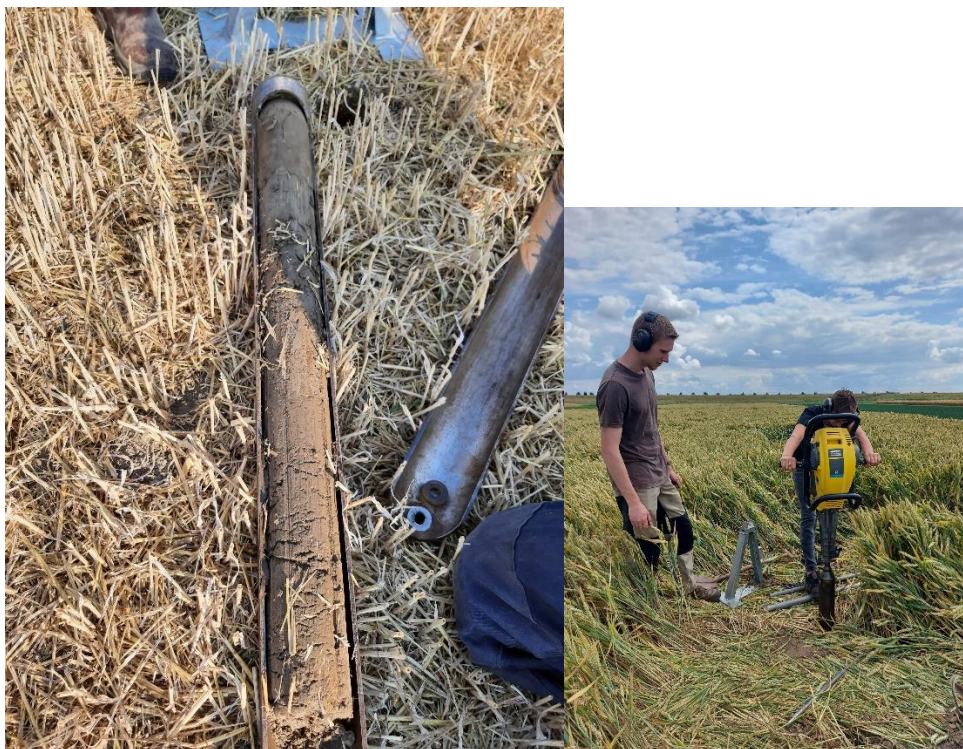
Figuur 21: Grondcilinder die vervolgens is beoordeeld op het aantal aanwezige wortels in het horizontale vlak.
