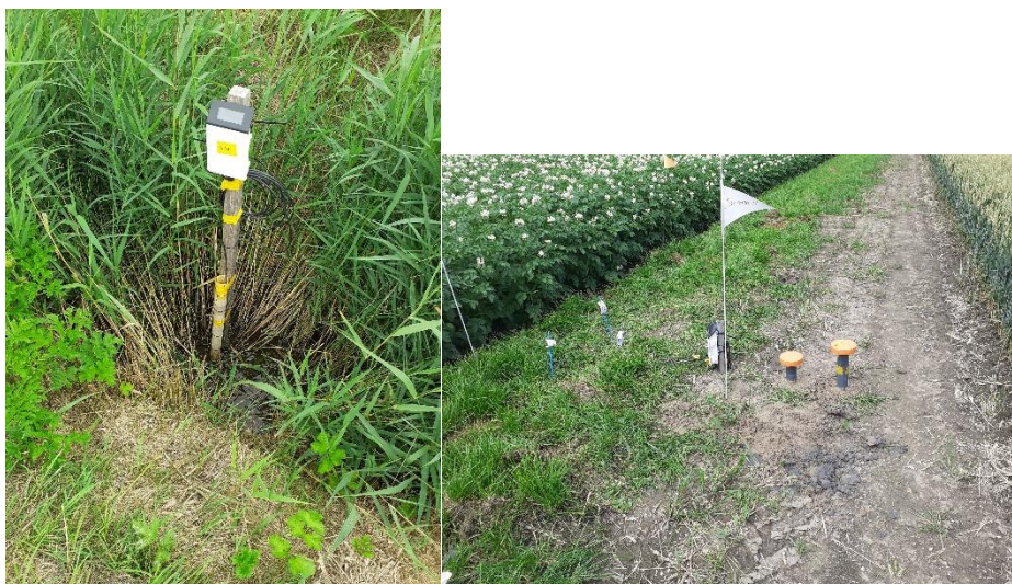
Figuur 3: Geplaatste sensoren op verschillende plekken links: sloot, en rechts: in de grasbanen van het proefveld. Het te gebruiken gebied tussen twee opgezochte druppelslangen is gemarkeerd met de blauwe stokjes, waarna er achtereenvolgens een data-box zichtbaar is waar het 3-tal bodemsensoren op de benoemde dieptes worden uitgelezen, en een tweetal Aquapins (te herkennen aan de oranje 'deksel'). Deze opstelling in de grasbanen was identiek voor de gekozen 4 grasbanen (t.b.v. de vier objecten zoet, zout, ploegen en niet ploegen).
