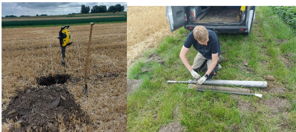
Figuur 5: Uitvoering beworteling-beoordeling met grond-kolomcilinderboor.
