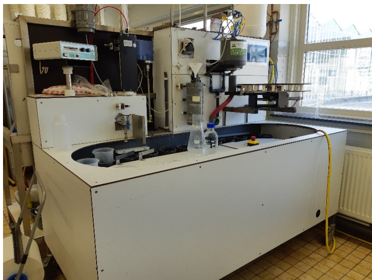
Figuur 3.2. Zonale centrifuge. Op de onderste carrousel worden de monsters in 1 L-bekerglazen naar de centrifuge geleid, op de bovenste carrousel worden de monsters na extractie in 150 mL-bekerglazen opgevangen. De kom van de centrifuge is uit veiligheidsoverwegingen in een houder aangebracht. De MgSO_4 wordt door leidingen in de kom van de centrifuge gebracht. Foto: WUR | Open teelten.
